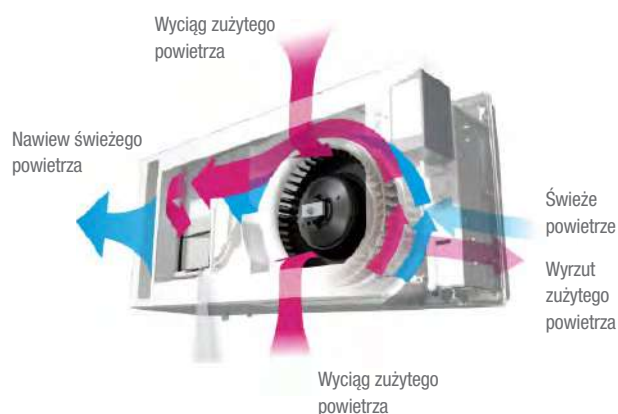
Przepływ powietrza na przykładzie decentralnego rekuperatora VL-50
