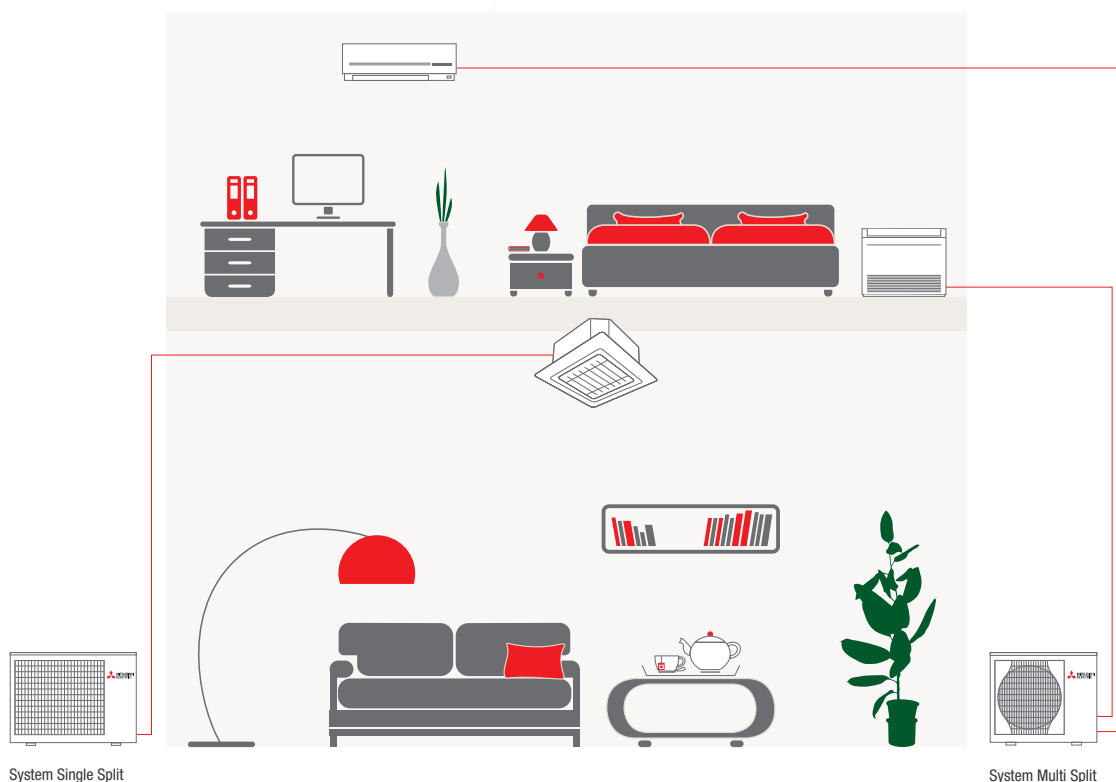
Instalacje Single Split i Multi Split
