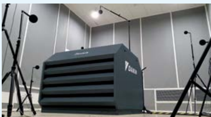
Pomiar poziomu mocy akustycznej w komorze akustycznej
